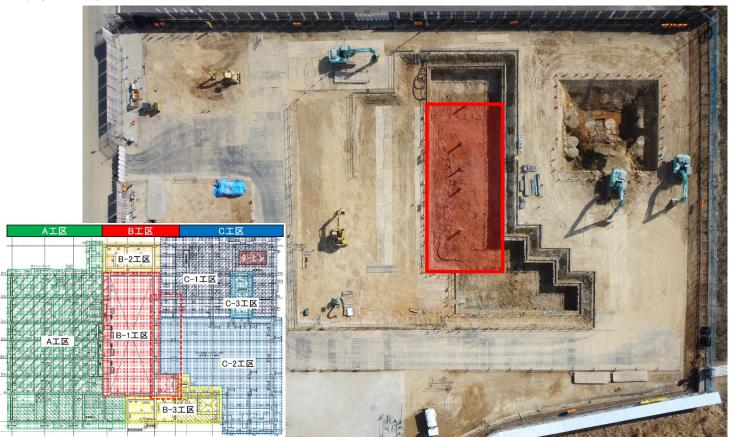
現在、B-1・2・3工区及びC-3工区の掘削が行われています。B-1工区はごみピット(赤枠)になります。
